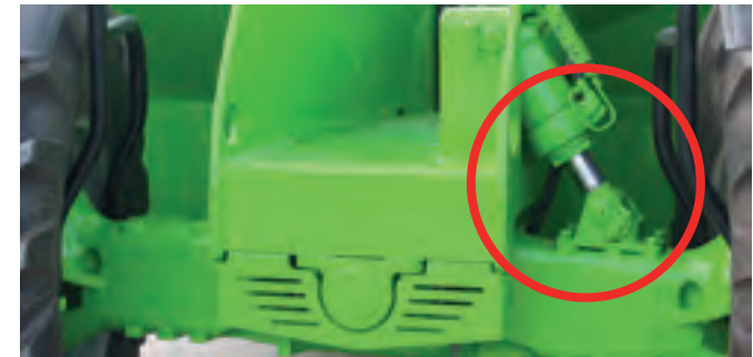
Sistema di livellamento per la correzione dell'inclinazione
