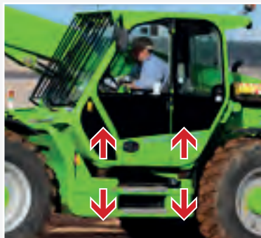
Cabina sospesa idropneumatica attivabile dall'operatore. Unica nel suo genere disponibile sul mercato.
