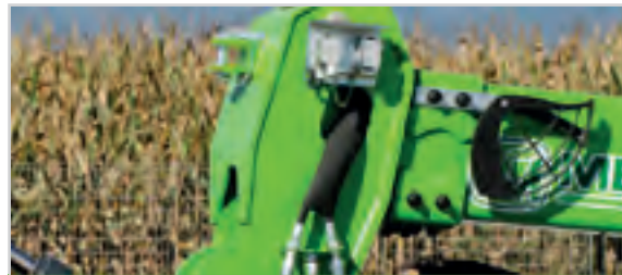
Tubazioni, cavi elettrici e linee idrauliche ausiliarie sono collocati all'interno del braccio per la massima protezione
