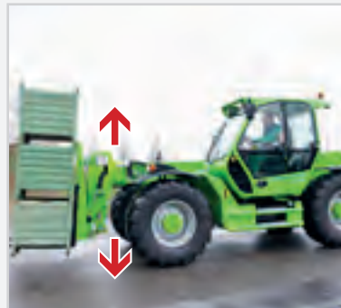
BSS sospensione Idropneumatica del braccio (opt). Inseribile dall'operatore, velocizza i trasferimenti e salvaguarda il carico e migliora la produttività. Si disattiva a velocità <3 km/h.
