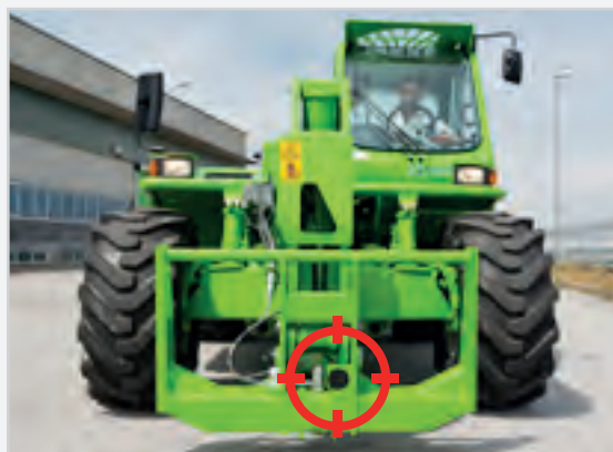
Sensore posto sulla zattera
